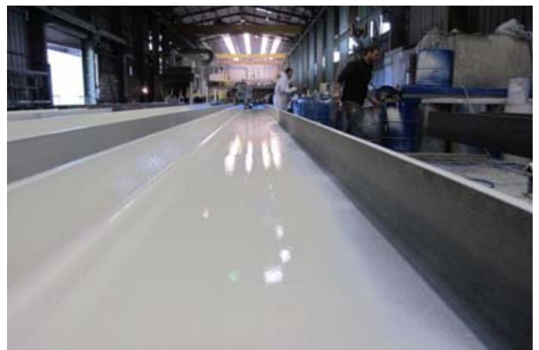
L'atelier peinture se trouve en bout de chaîne. De plus en plus de charpentes métalliques sont peintes.
